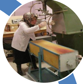
Bridgman/stockbarger tekniğiyle kristal büyütme ünitesi
