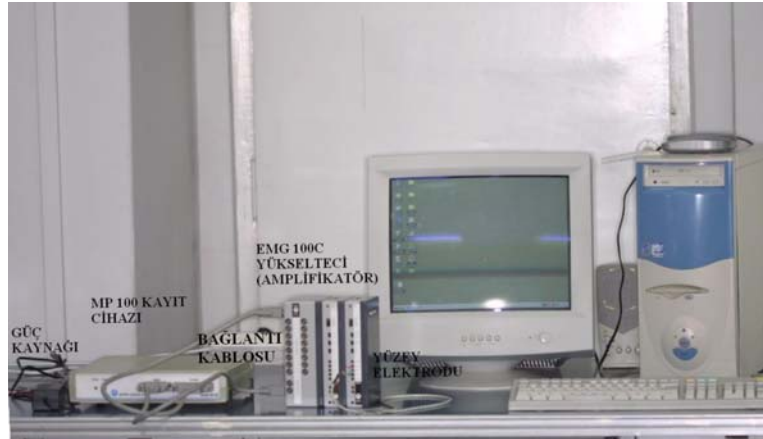
Şekil 9: EMG kaydının yapıldığı sistemin genel görünüşü
