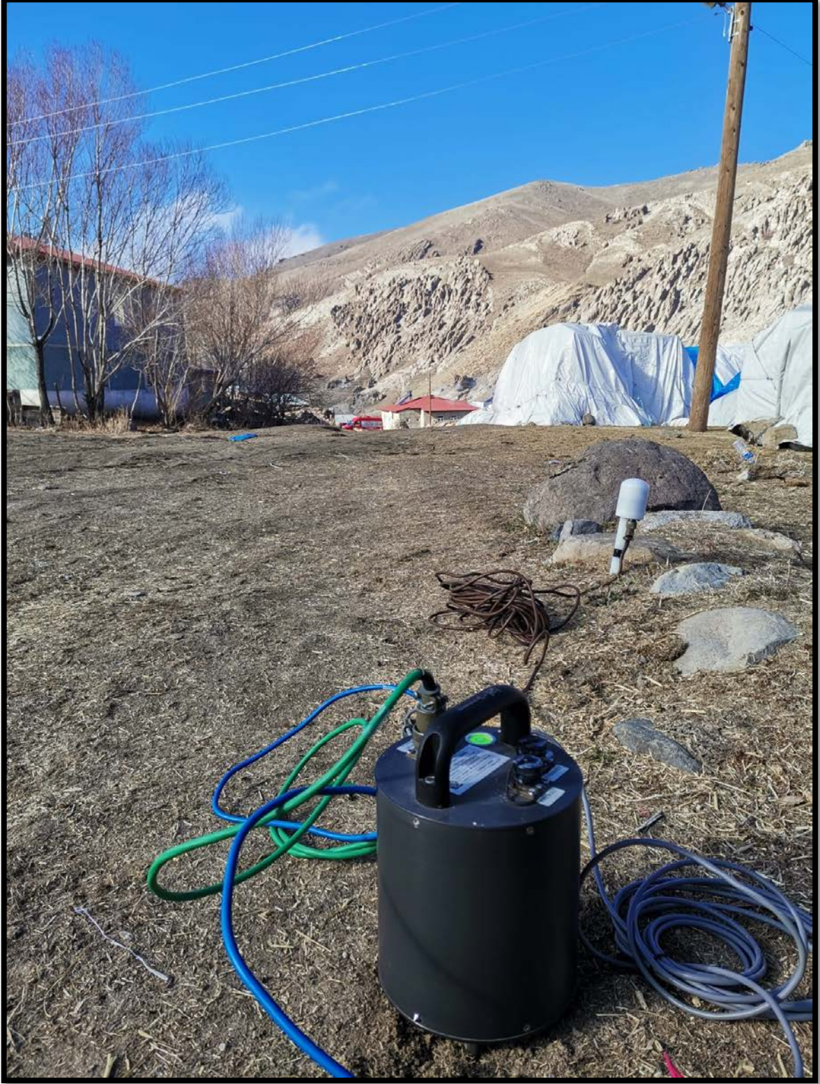
Şekil 13. Topçu Köyünde yapılan Mikrotremor ölçümleri
