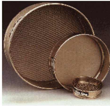
Şekil 9. Elek analizinde kullanılan elekler
